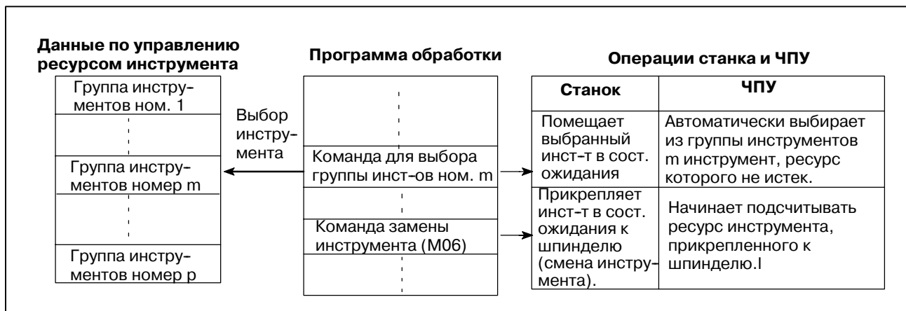
Рис. 10.2 (b) Выбор инструмента программой обработки
