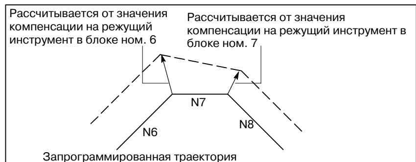
Рис. 14.4 (c) Изменение значения коррекции на режущий инструмент
